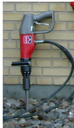
Гидравлический отбойный молоток HYCON HH10 – это легкий отбойный молоток, предназначенный для горизонтальных работ по разрушению кирпичных стен, бетона и т.д.
